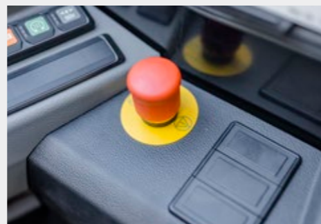
Bouton d'arrêt d'urgence rapidement accessible , permettant de mettre immédiatement la machine en état de sécurité en cas de danger.
