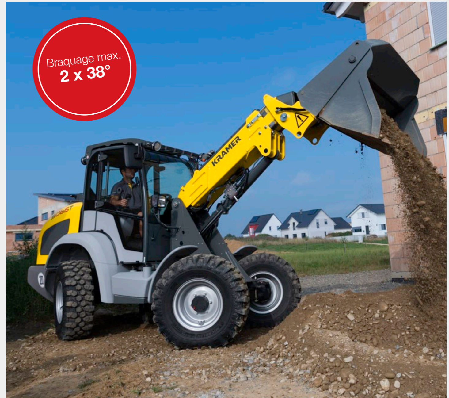
Direction quatre roues : particulièrement maniable dans les espaces restreints
